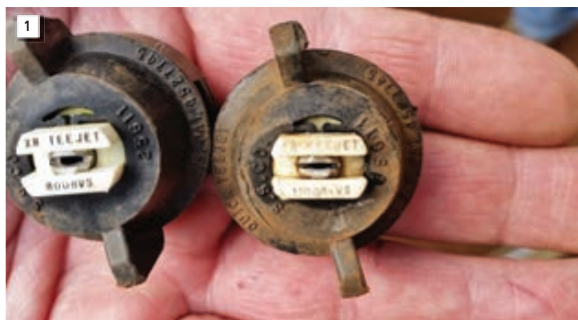
▲ 1: Twee naasliggende spuitkoppe (80° en 110°) wat op ‘n spuitbalk gemonteer was, beide in dieselfde kleur (= volume lewering), maar wat teen verskillende hoeke spuit. ‘n Tipiese fout op algeheel-breedwerpige bespuitingspuitbalke.
